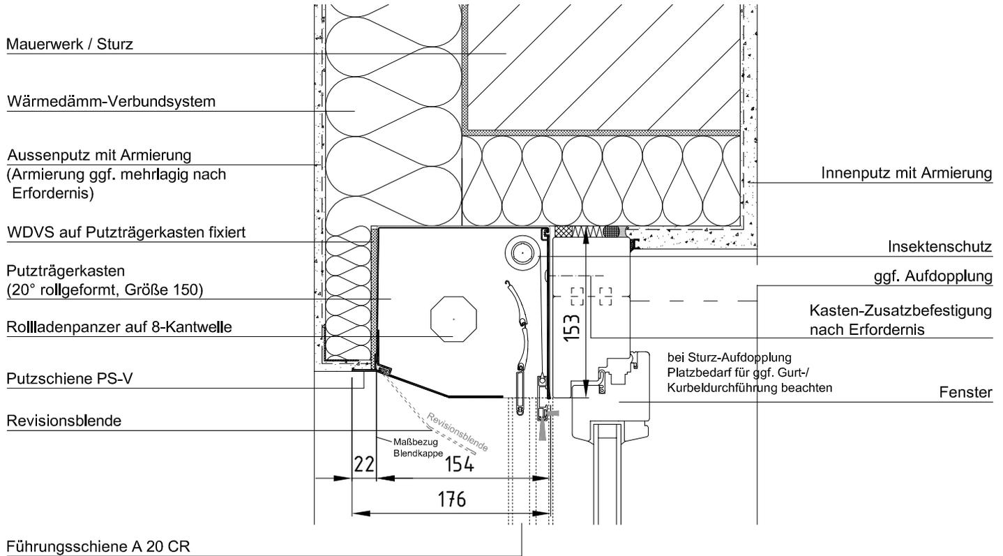
Der Putzträger-Kasten darf sich nicht bewegen und ist zusätzlich zu befestigen.
